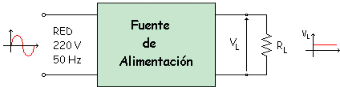
Tenemos que diseñar la Fuente de Alimentación. Partimos de una senoidal del enchufe.
