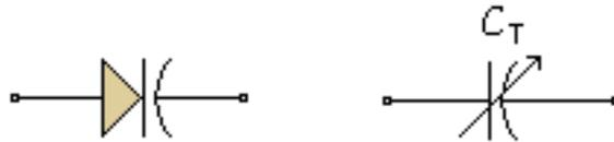
Las regiones p y n se comportan como las placas de un condensador y la zona de deplexión es como el dieléctrico.
